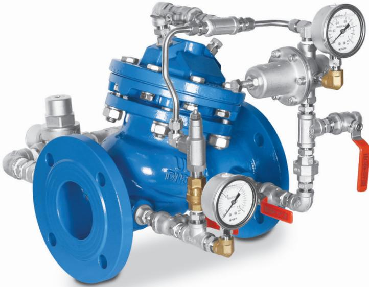
모델 W01-020-AC 밸브는 부식 방지 구조를 포함하여, 밸브 자체 부식 발생을 방지하며, 유입측(1차측) 높은 압력을 유량의 변동 또는 압력의 변화에 관계없이 유출측(2차측)의 설정된 낮은 압력으로 자동적이고 안정적으로 일정하게 유지합니다.
