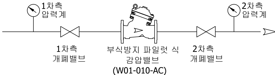
그림 2 부식방지 파일럿 식 감압 밸브(W01-010-AC)의 설치 예시도
