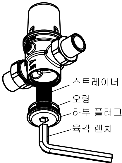
그림 4 감압 파일럿 밸브의 스트레이너 청소 방법
